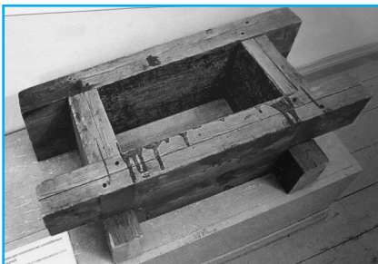
Илл. 7. Форма для изготовления землебитных кирпичей. Использовалась для реставрации Приоратского дворца в XX веке
